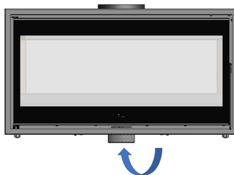
Figura nº6 - Conducción del aire para la cámara de combustión Verona 1000.
